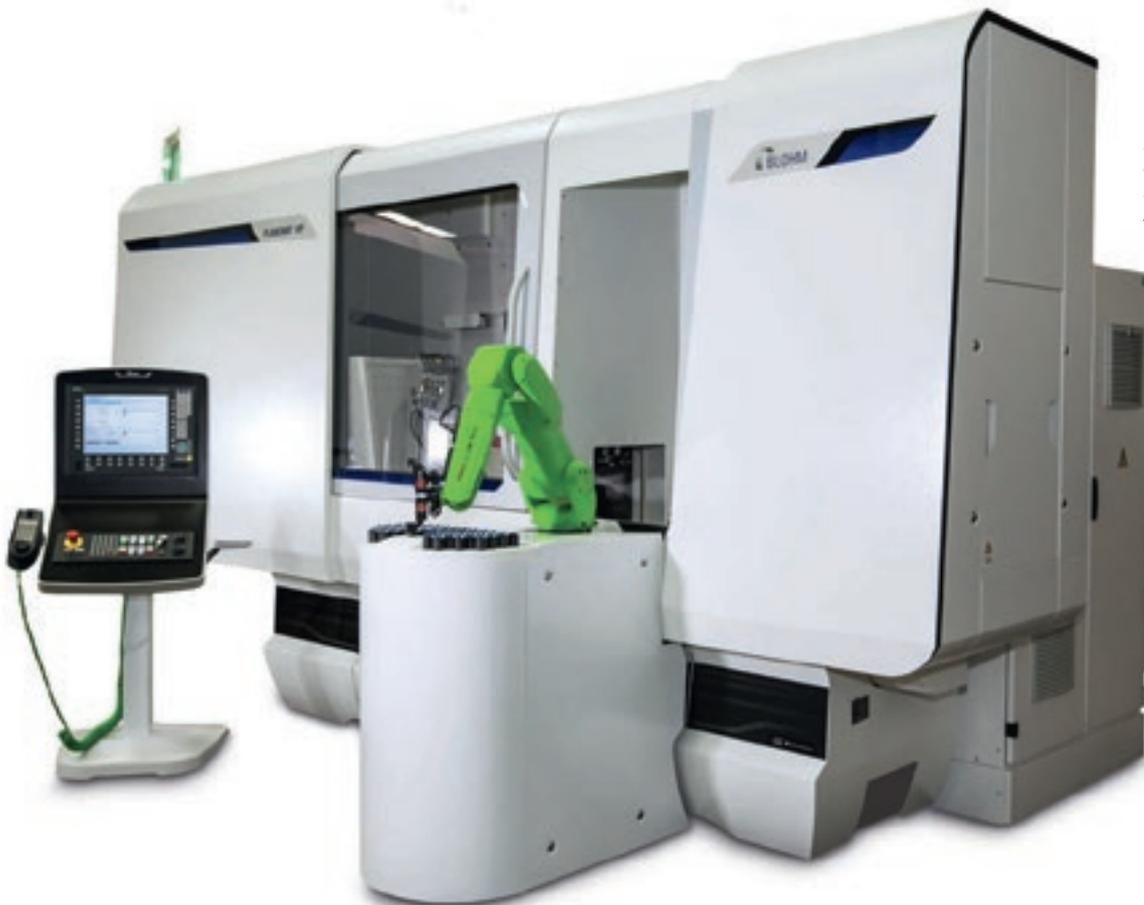
Der kollaborative FANUC CR-7 ermöglicht die Zusammenarbeit Mensch-Maschine ohne Sicherheitskäfig oder Einhausung
