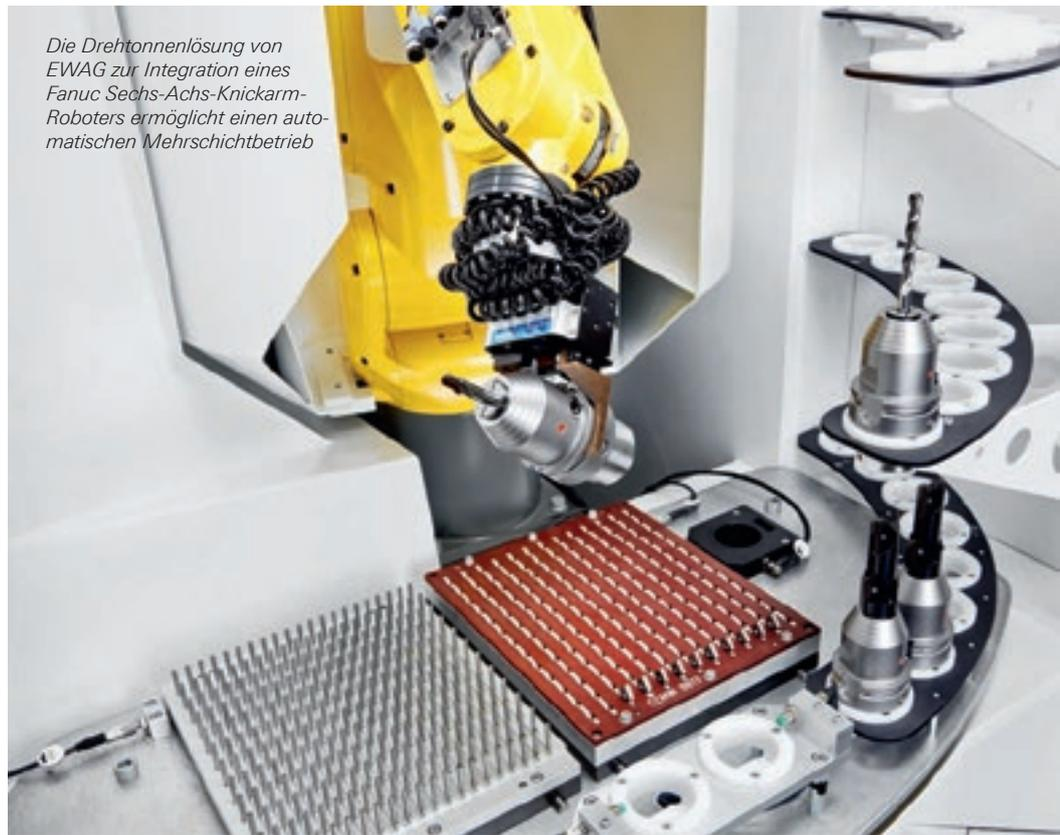
Die Drehtonnenlösung von EWAG zur Integration eines Fanuc Sechs-Achs-Knickarm-Roboters ermöglicht einen automatischen Mehrschichtbetrieb
